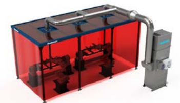
Confinement local d'une cellule de soudage robotisée avec MCP-GO et
