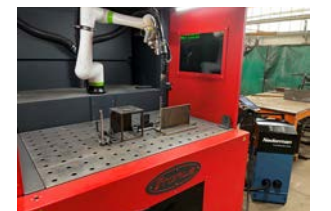
Extraction des fumées à la torche pour un poste de travail cobot avec FE GoMax
